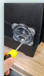
4. Débranchez le câble et dévissez l'écrou de la cellule électrolytique à l'aide de la clef fournie avec le SPA
